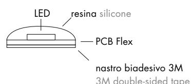
Nella versione IP65 i chip LED sono coperti da una resina, che rende la strip LED impermeabile e ne consente così l'installazione in ambienti esterni.
