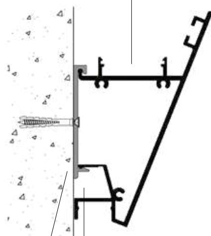
profilo per fissaggio a muro
